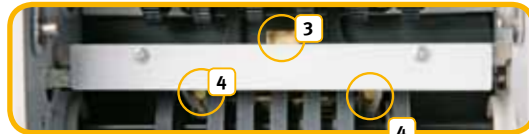
3 Infrarode / UV-sensor 4 Rechter en linker telsensor
