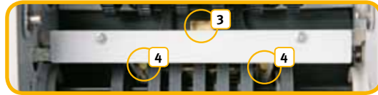
3 Infrarossi / Sensore UV 4 Sensore di conteggio a destra e a sinistra
