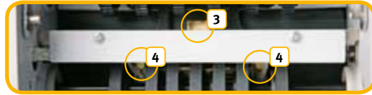
3 Infrarot / UV-Sensor 4 rechter und linker Zählsensor
