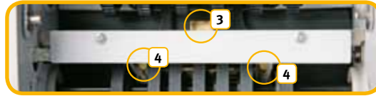
3 Αισθητήρας υπέρυθρης / υπεριώδους ακτινοβολίας 4 Δεξιός και αριστερός αισθητήρας μέτρησης
