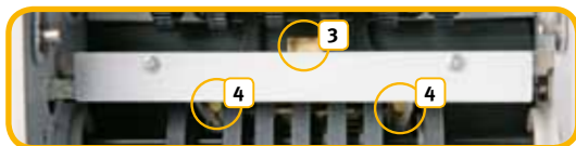
3 Infrapuna/ UV-sensor 4 parempoolne ja vasakpoolne lugemisandur
