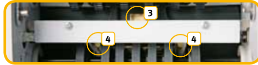
3 Sensor de infrarrojo/UV 4 Sensores de cuenta derecho e izquierdo
