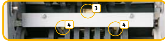
3 Senzor infračerveného resp ultrafialového světla 4 Pravý a levý počítací senzor
