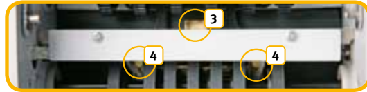
3 Infrarouge/ Capteur UV 4 Capteur de comptage gauche et droit
