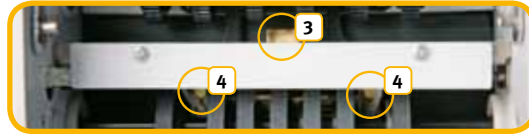
3 Sensor de infravermelhos/UV 4 Sensor de contagem direito e esquerdo
